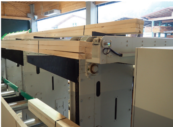
Ein Paternoster bringt das Holz nach oben, wo die Lagenbildung erfolgt – in diesem Fall handelt es sich um gebündelte Latten
