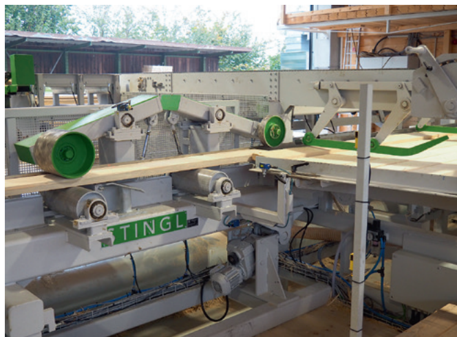
Einzug in die Hobelmaschine: Die Mechanisierung von Stingl taktet die Hölzer Stück für Stück lückenlos ein
