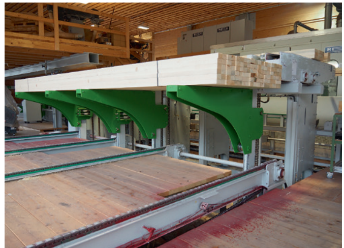
Paketbildung: Stapelungen übergeben die Holzlagen auf das zu bildende Paket, danach gibt es noch einen Querkettenförderer als Puffer
