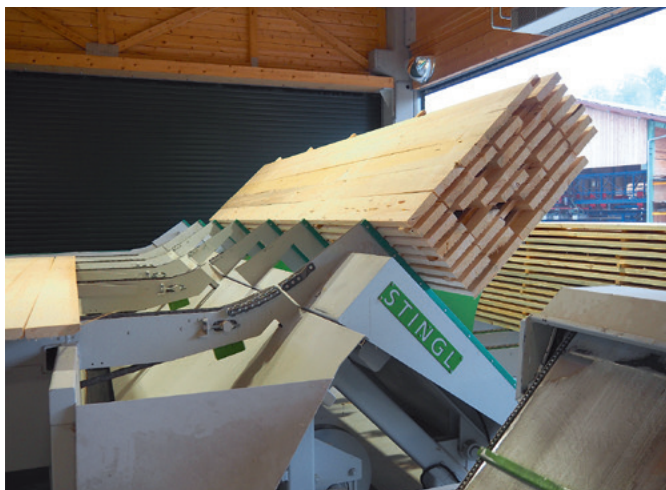
Hier geht es los: Paketaufgabe mit lagenweiser Entstapelung inklusive Sammler für die Latten
