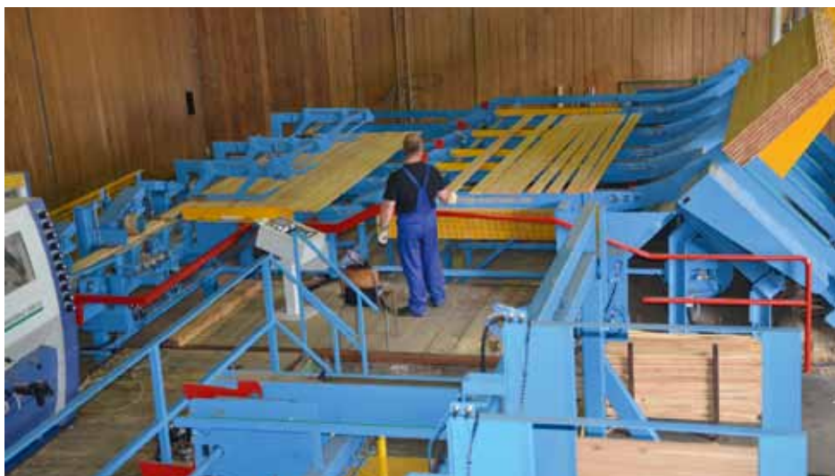
Die Paketaufgabe mit Lattenabtransport und Hobelbeschickung
