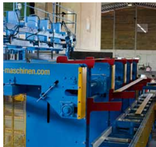
Der Paternosterstapler (auch für Bauholz im Einsatz) ergänzt die Mechanisierung optimal
