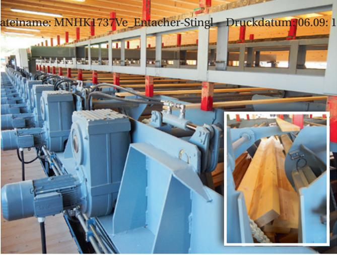
20 Schrägboxen stehen für die mitunter sehr großen Dimensionen (kl. Bild) bei der Sortierung zur Verfügung
