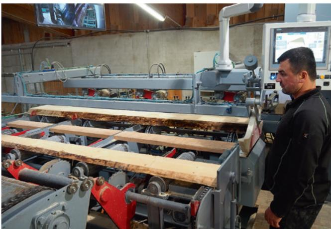
Der Mitarbeiter überwacht die Zuführung der Bretter und Bohlen zur Nachschnitt- und Besäumanlage NBA von Stingl
