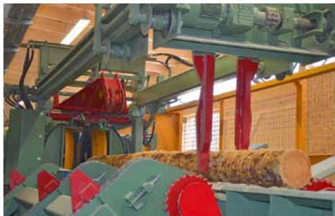
Kompakte Vorschnittlösung: Die Eindrehvorrichtung bringt den Stamm in die richtige Position, dann folgt der Spaner
