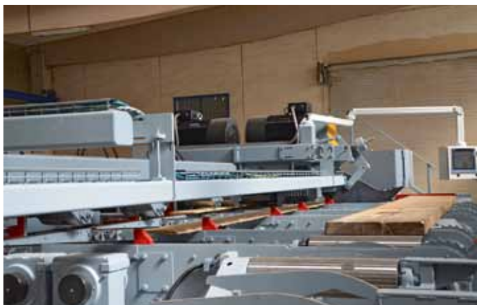
Einzugsstisch der neuen Besäum- und Auftrennkreissäge der Maschinenfabrik Stingl mit nachfolgender Positionier- und Zentrierereinheit
